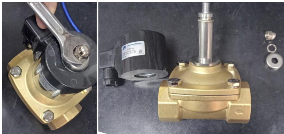
Figura 42 - Abrir o parafuso superior da válvula e remover a bobina.
