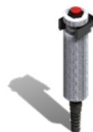
Botão de pulverização manual localizado no interior da cabine do trator.
