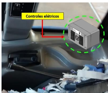
Controles elétricos de altura e ângulo da barra de pulverização.
