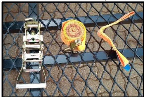
Fig. 3.21: Componentes para amarração: catraca; cinta e laço costurado.
