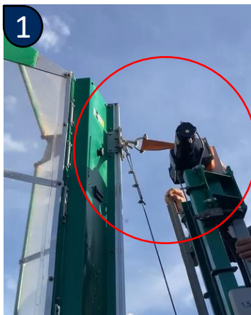
Fig. 3.11: Cinta de segurança no superior da barra
