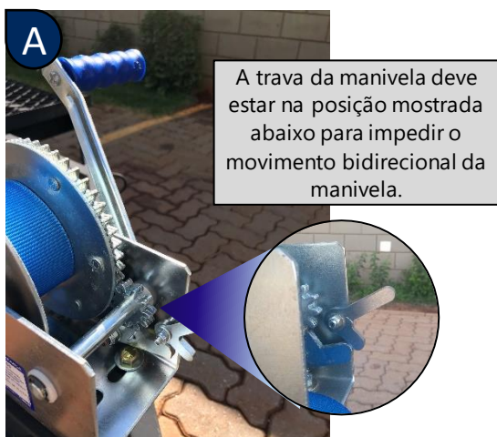
Fig. 3.16: Trava da manivela em modo catraca (unidirecional)
