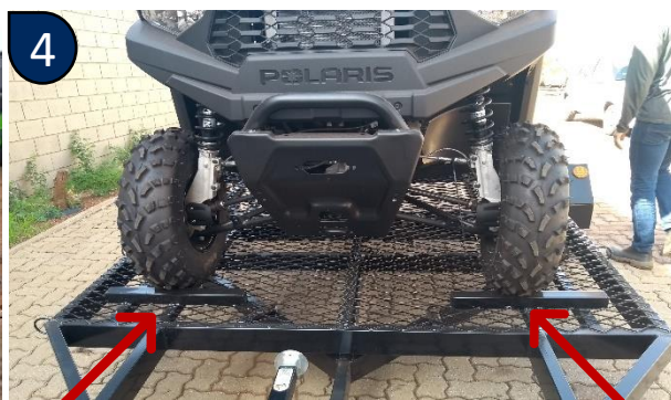
Fig. 3.15: Pneus do UTV centralizados no apoio dos rodados
