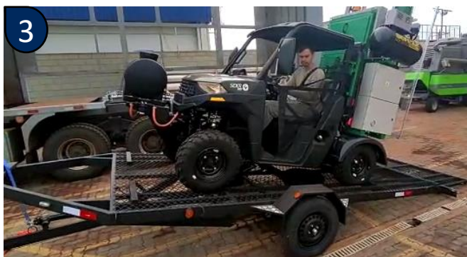
Fig. 3.14: Sider UTV em processo de subida
