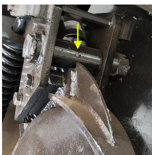
Fig. 10.9: Articulação do conjunto disco de aplicação adubo e inseticida/nematicida
