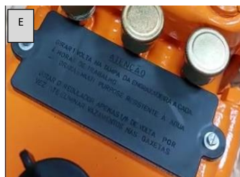
Fig. 8.6: Placa de instruções: observar os parafusos laterais que devem ser removidos.
