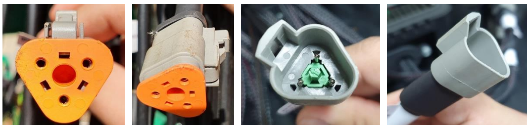
Fig.6.25: Conexões triangulares fêmeas (duas à esq.) e machos (duas à dir.).
