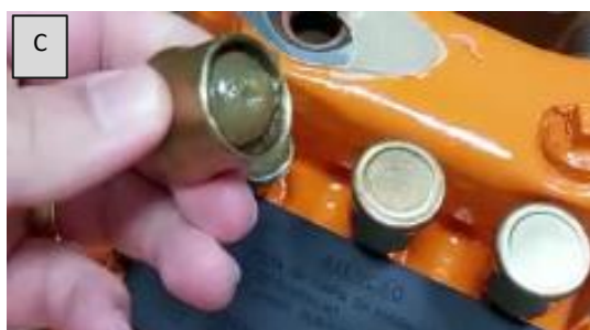
Fig. 8.4: Interior da tampa com graxa.
