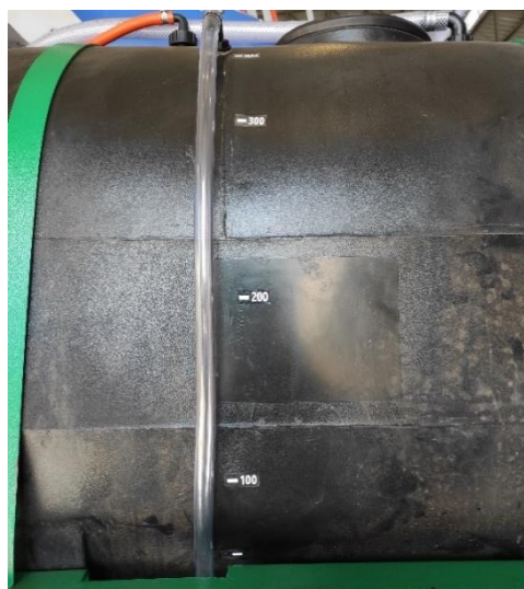
Fig. 7.6: Foto do nível do tanque reservatório.
