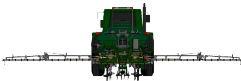
Fig. 6.16: barras de pulverização laterais estendidas (se equipado).
