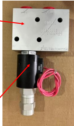
Fig. 8.8: PWM e Bloco hidráulico.
