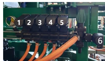
Comando das seções (1 a 5) e válvula geral (6).
