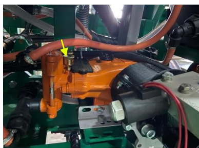
Fig. 10.8: Bomba de pistão (lubrificação das gaxetas pág. )
