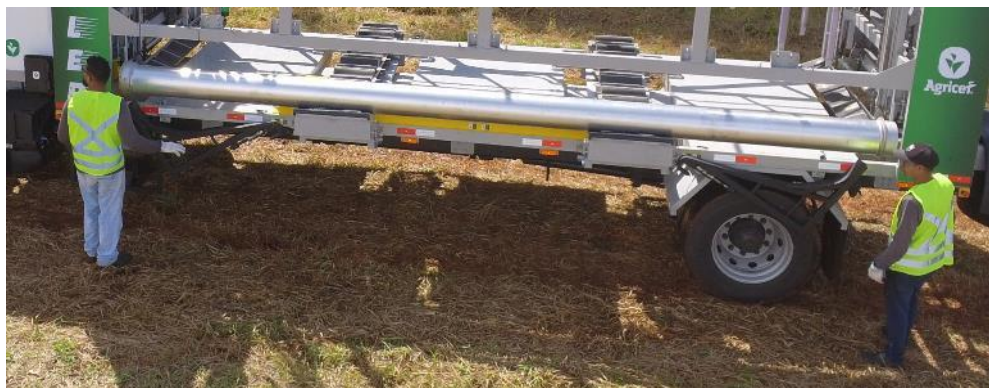
Fig. 5.10: Os operadores devem colocar os tubos na orientação pré-determinada (sempre carregando todos de mesma maneira).
