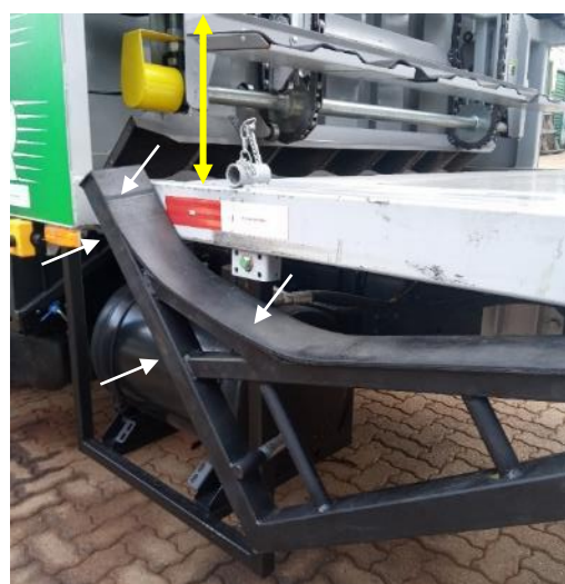
Fig. 5.3: Posição de carregamento; dá abertura (indicada pela seta amarela) para deposição dos tubos.
