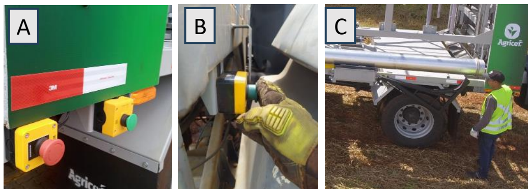
Fig. 5.11: Os botões de alimentação (A) devem ser pressionado (B) do mesmo lado escolhido para carregamento (C) e simultaneamente pelos dois operadores.
