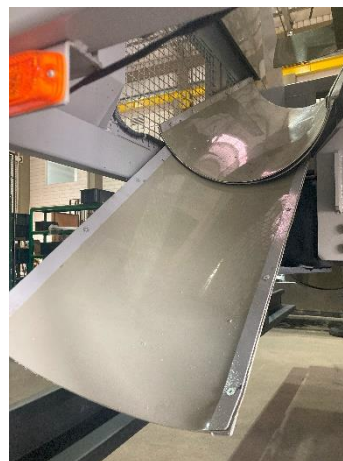
Fig. 5.32: Rampa de descarregamento de abraçadeiras pela lateral.
