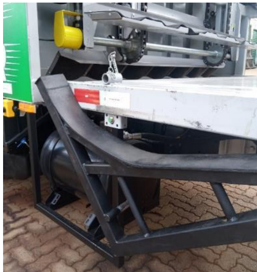
Fig.4.9: Dispositivo de descarregamento em posição de abertura para carregamento de tubos
