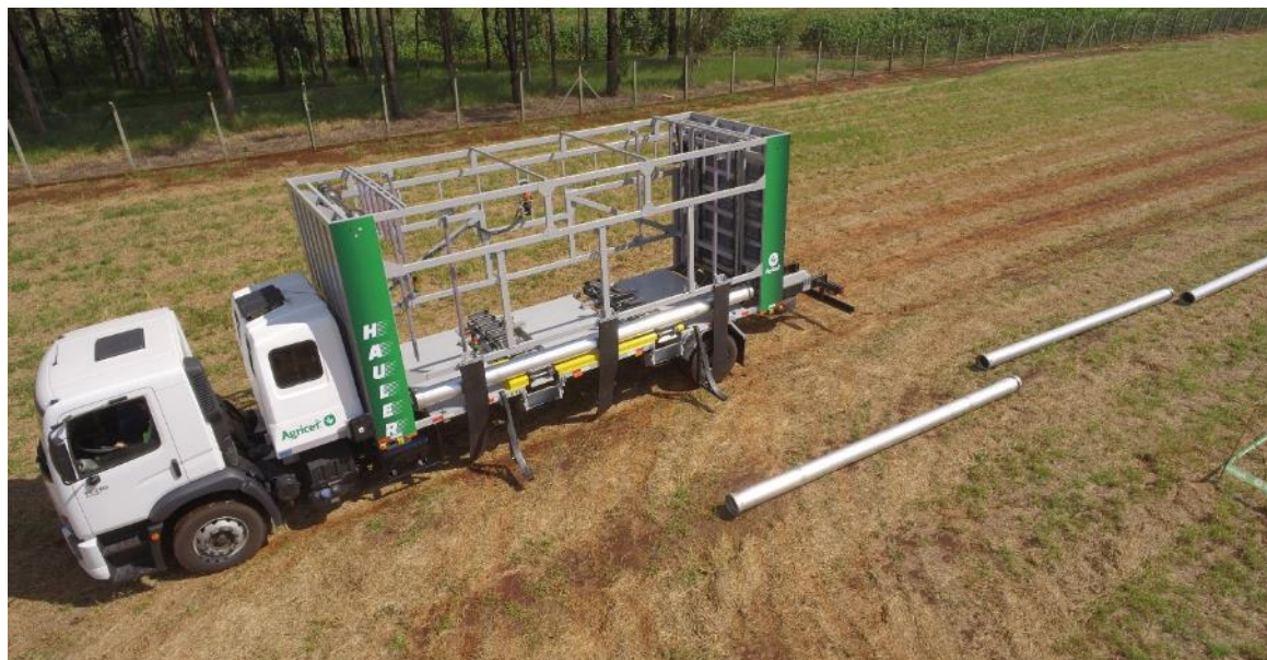
Fig. 5.27: Os tubos são liberados automaticamente com o comando do operador na tela.
