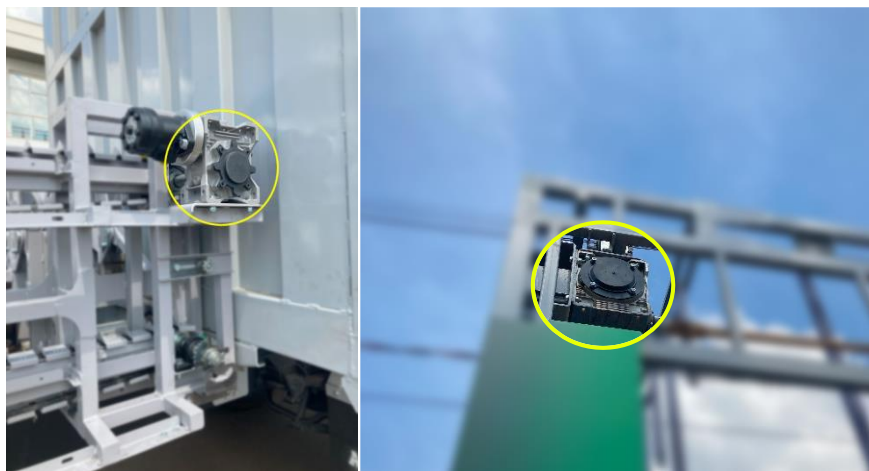
Fig. 6.2: Redutores tipo rosca sem fim e coroa (0,55 L) nas esteiras horizontais e mecanismos de distribuição de abraçadeiras, enquanto redutores tipo rosca sem fim e coroa (4,5 L) localizam-se nas esteiras verticais.
