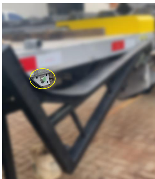
Fig.4.11: Sensor de proximidade do dispositivo de descarregamento
