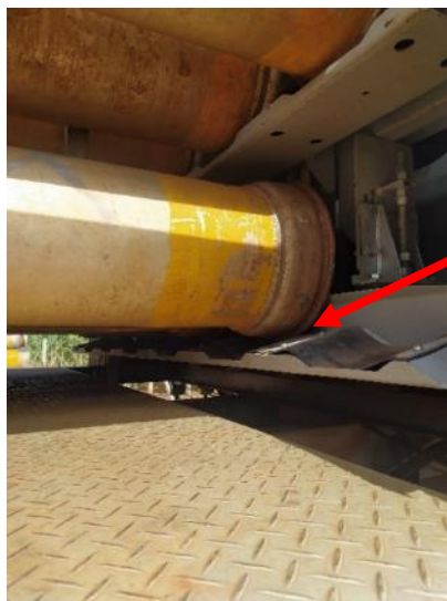
Fig. 5.15: tubo carregado apoiado na talisca da esteira vertical
