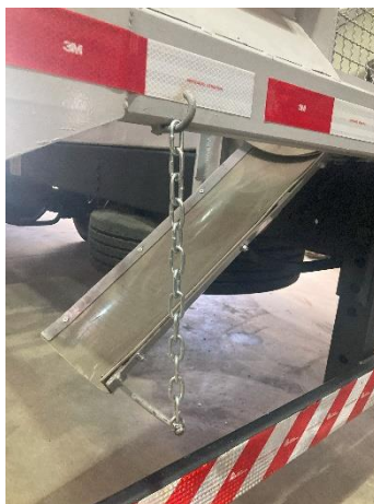
Fig. 5.31: Corrente de segurança da rampa.
