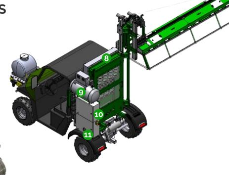
BARRA DE PULVERIZAÇÃO: barra de ferro contendo tubos ejetores para a pulverização do produto na lavoura.
